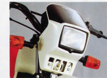
つ快適なオフロード走行を可能にする設計を施しています。また 透過光式のメーターパネルにはスピードメーター 水温計 タコメーターを装備。明るいV-25W/25Wのスクエア・ヘッドライト。オイル警告灯 大容量ジェネレーターとレギュレーター、指針式のブレーキ摩耗インジケーター
